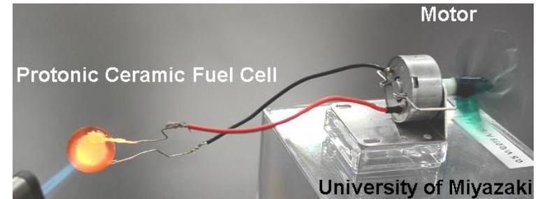
ライターの燃料と熱でモーターが回る！
