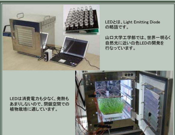
図3. 白色LEDを実装した人工気象器による植物栽培の様子
