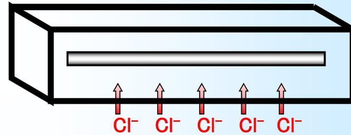
塩化物イオンがコンクリート内部の鉄筋に浸透する。
