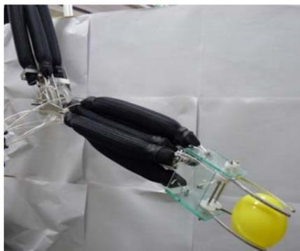
マッキベン型空気圧人工筋を使ったヒューマノイドロボットの開発を目指しています。空気圧で駆動するため柔軟性があり、従来のロボットより人間に近い動作が可能になります。
