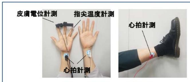
図 11 生理計測のための計測器の装着の様子
