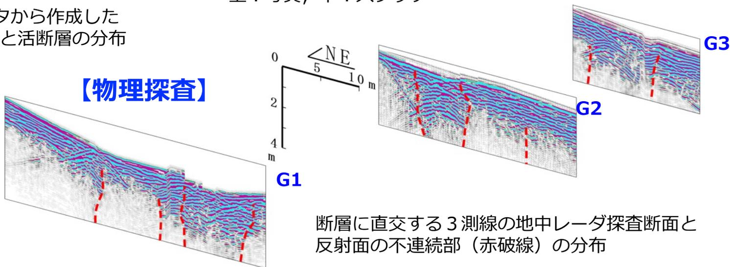
断層に直交する3測線の地中レーダ探査断面と反射面の不連続部（赤破線）の分布
