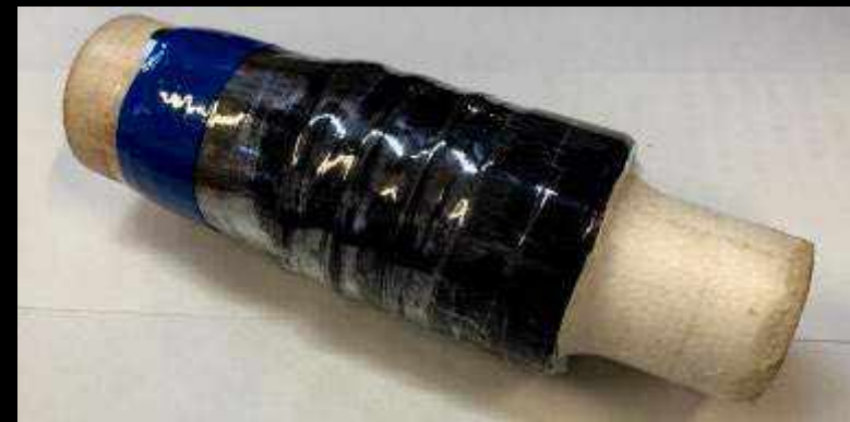
図3 熱硬化後（熱収縮テープ付き）
