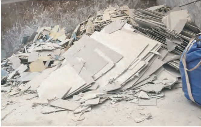
写真3 中間処理工場における廃石膏ボードの回収状況(第5回)
